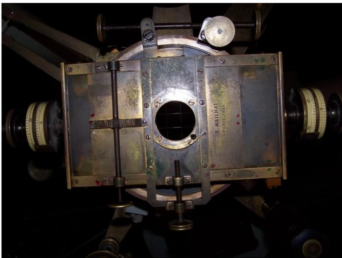
*El micrómetro de hilos del Observatorio Fabra tiene fibras de dos grosores. En la imagen se ven las más gruesas, de 150 micrones; las más delgadas, que forman una cuadrícula, necesitan iluminación externa para poderse ver. (Imagen cortesía del autor)*
